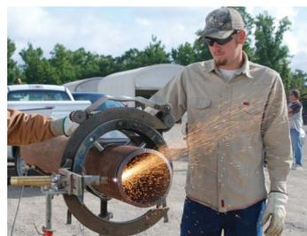
Mechanisiertes Schneiden mit tragbaren Geräten
