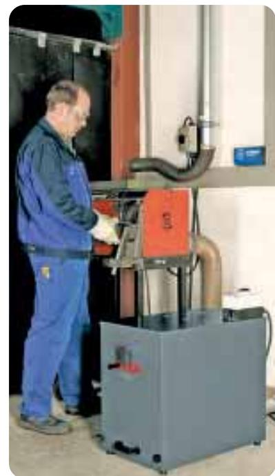
Kleinentstauber TK an einer Entgratmaschine
