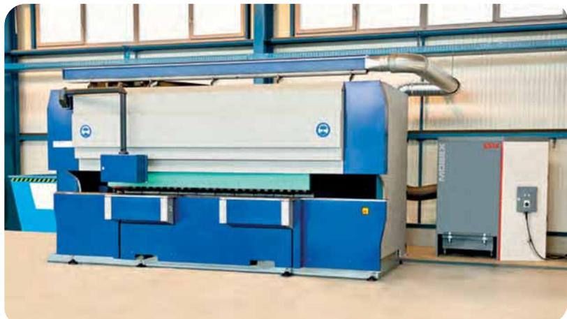
MOBEX P-24 an einer Fasen-Bandschleifmaschine.
