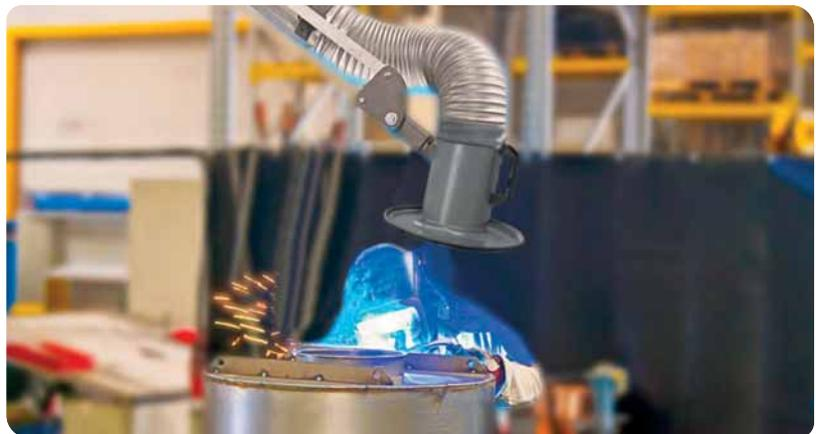
Für eine optimale Raucherfassung an bis zu vier Absaugstellen oder an kleineren Schweißkabinen bietet ESTA die stationäre Schweißrauchfilter-Serie **MOBEX F** an. Die „Einsteiger-Modelle“ im stationären Bereich eignen sich für Luftmengen bis zu 4.500 m<sup>3</sup>/h.
