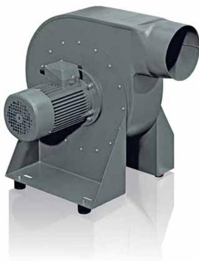
**Absauggebläse RG mit Absaugarm** sind eine kostengünstige und effektive Art der Absaugung. Der Staub oder Rauch wird mittels eines Gebläses über den Absaugarm erfasst und ohne Filtrierung in den gewünschten Bereich (i. d. R. ins Freie) geleitet. Sinn und Zweck ist es, die Abluft an einen anderen Ort innerhalb oder außerhalb des Gebäudes zu transportieren.
