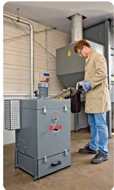
OM-8 an einer Bandschleifmaschine
