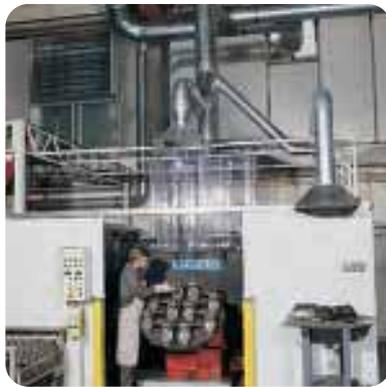
Absaugung an einem Roboterarbeitsplatz
