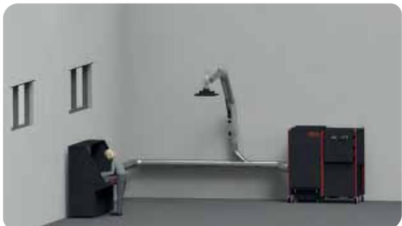
Der geringe Platzbedarf und das niedrige Betriebsgeräusch der Entstauber erlauben die Aufstellung direkt im Arbeitsbereich.
