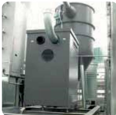
Filtereinheit mit Explosionsschutz
