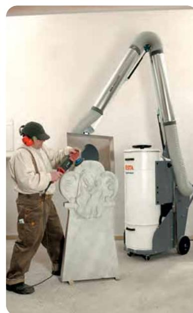
DUSTOMAT-16 M – direkte Absaugung des feinen Steinstaubes
