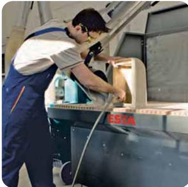
Absaugtisch mit Holzlattenrost und Absaugarm
