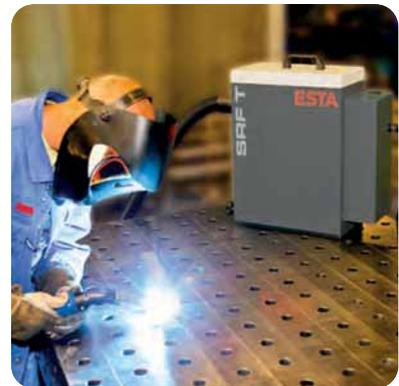
SRF T-2, Direktabsaugung an einem Schweißbrenner
