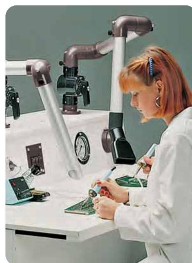
Mehrere Absaugarme für die Absaugung von Lötrauch
