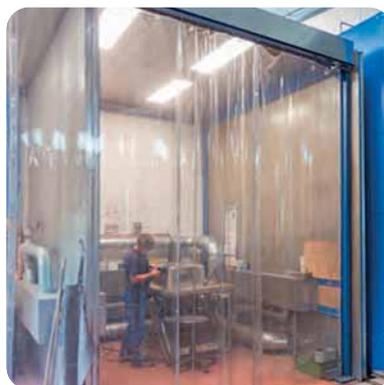
An den vier Schleifkabinen sind Nassabscheider installiert, um die teilweise explosionsfähigen Stäube sicher abzuscheiden
