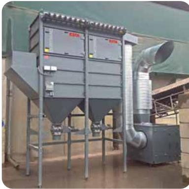
Absaugereinheiten DUSTMAC S-66 und Mitteldruckventilator
