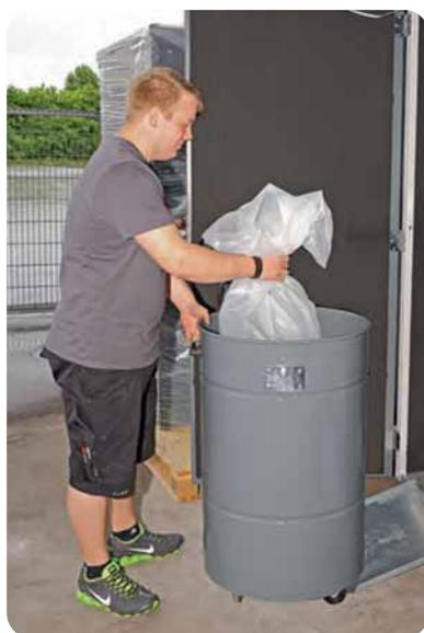
Der fahrbare Staubsammelbehälter mit eingelegetem Plastiksack ermöglicht die leichte und staubfreie Entsorgung des abgesaugten Schmutzes.
