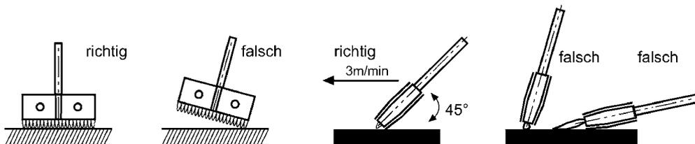
Brenner vorsichtig auf Oberfläche aufsetzen. Brennerreinigung zur Oberfläche 45°. Die Spitzen der Flammkegel müssen die Oberfläche berühren.
