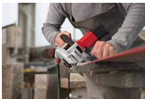
Stufenlose Winkeleinstellung für Gehrungsschnitte von 0-45°
