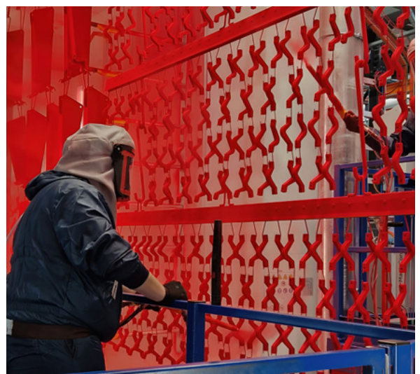
↑ Ein Mitarbeiter der Firma HORSCH beim Pulverbeschichten. Die Druckluft wird auch für die Atemluft genutzt.
