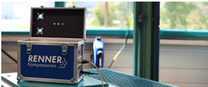
↑ Messkoffer zur Bedarfsermittlung im Einsatz
