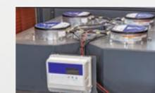
Die Filtertürme der neuen Generation verfügen über hocheffiziente EC-Ventilatoren für einen regelbaren und damit energiesparenden Anlagenbetrieb.
