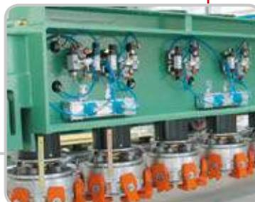
Modulare Verteiler auf Maschinen oder Automationslinien.
