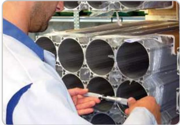
Die Qualitätskontrolle wird anhand der Norm UNI ISO 2859 durchgeführt. Für jedes Detail gibt es spezifische Kontrolldatenblätter. Auf jedem Produktdatenblatt sind die durchzuführenden Kontrollpunkte aufgeführt; auf Basis einer kritischen Quote und des jeweiligen Produktes wird ein Kontrollfaktor LQA (minimal akzeptierte Qualität) zwischen 1.5, 2.5 und 6.5 festgelegt.
