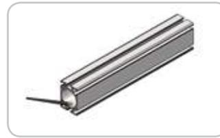
3.4 **Bohrung:** das Bohrloch muss mittig auf der glatten Oberfläche des Rohres gesetzt werden. Hilfreich ist hierfür eine Bohrschablone.
