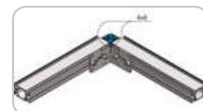
4.4 **Die "L" und "T" Verbinder** werden mittels der eigens dafür vorgesehenen Winkel befestigt. Bei der Verbindung des Profilrohres HBS25 ist es erforderlich, an der Engseite die Kante um ca. 6 mm abzurunden.
