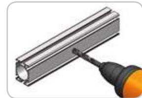
Der max. Durchmesser des Bohrloches und der Abschrägung darf den gem. Tabelle empfohlenen Durchmesser nicht überschreiten
