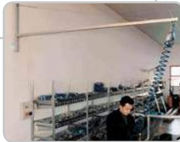
Tischschwenkarme aus eloxiertem Aluminium als Halterung von pneumatischen Werkzeugen.
