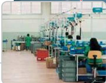
Laufwagen auf Aluminiumprofilrohr als Halterung und zur Versorgung von pneumatischen Werkzeugen.
