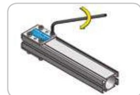
4.3. **Festziehen der Schrauben:** ist sehr sorgfältig durchzuführen. Die Schrauben werden gut festgezogen, ohne jedoch zu übertreiben, um das Gewinde nicht abzudrehen. Das Schraubenanzugsdrehmoment für M6-Schrauben reicht von einem Minimum von 10 N·m bis zu einem Maximum von 13,5 N·m (120 In. lba).
