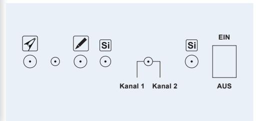
Das Clean Marker Brush-IT P Einbaugerät verfügt über eine automatische Elektrolytzufuhr mit einem oder einem zweiten optionalen Kanal. Hiermit ist es möglich gleichzeitig mit Bürste und Elektrode zu arbeiten, oder aber auch zwei unterschiedliche Elektrolyte (z. B. Reinigen und Beschriften) zum Einsatz zu bringen.
