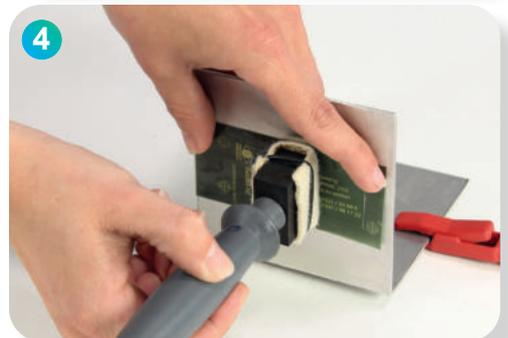
Speziell für Brush-IT Geräte stehen die Flächenreinigungswerkzeuge zur Verfügung. Diese sind einfach in der Handhabung und flexibel einsetzbar, auch dank der im Lieferumfang enthaltenen Teleskopstange, die auf 3 m ausziehbar ist. Ein Kabel mit der Länge von 8 m macht die Werkzeuge auch weitgehend unabhängig vom Standort des Gerätes.
