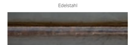
**Die smarte Lösung von Lorch:** Der MicorMIG Pulse-Lichtbogen bringt weniger Energie ins Werkstück ein und vermeidet so unnötige Anlauffarben. Zeitaufwendige und kostenintensive Nacharbeit, beispielsweise für das Entfernen der Anlauffarben, werden mit dem MicorMIG Pulse-Lichtbogen reduziert. Und das Ganze bei sauberer Wurzel-erfassung.
