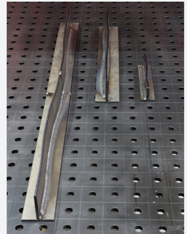
Pendeln – linear, Kreisbahn oder entlang des Bauteils.
